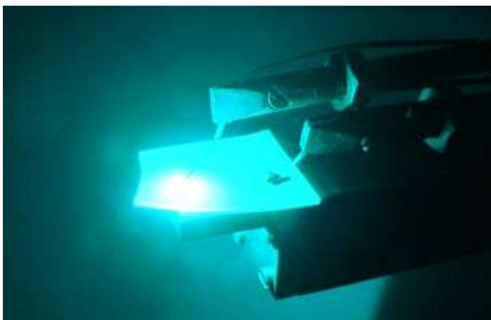
Abb. 1: On-Wafer-Test einer Elektrolumineszenz-Struktur mit semipolaren GaInN-Quantenfilmen.
